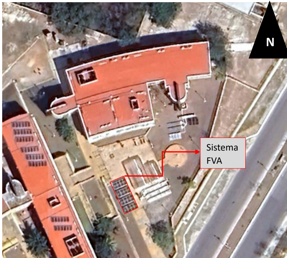
Figura 2. Orientación del sistema fotovoltaico con una declinación hacia el este de 24.61°.
